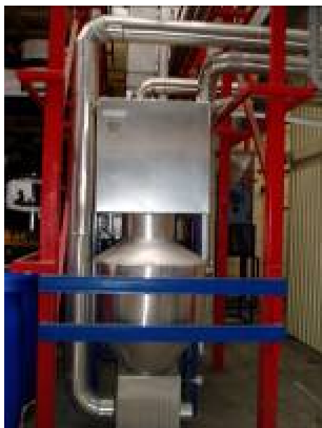
Slika 7. Katalitički reaktor (R-15) i rekuperator toplote (REK-24)
