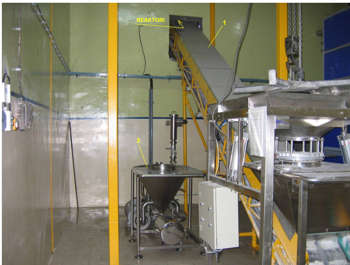
Slika 2. Uređaji za doziranje sirovina u zatvorenom sistemu
