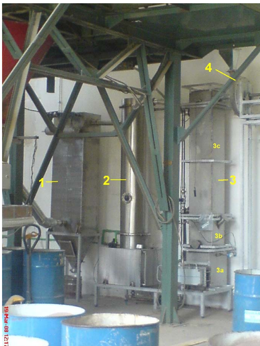
Slika 3. Oprema za za prečišćavanje aspiracionih gasova
