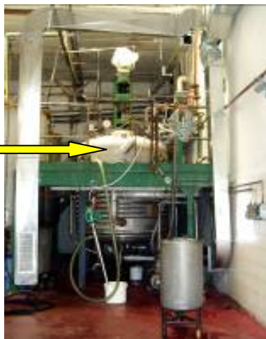
Slika 5. Reaktori za sintezu herbicida (HR-1/HR-2)
